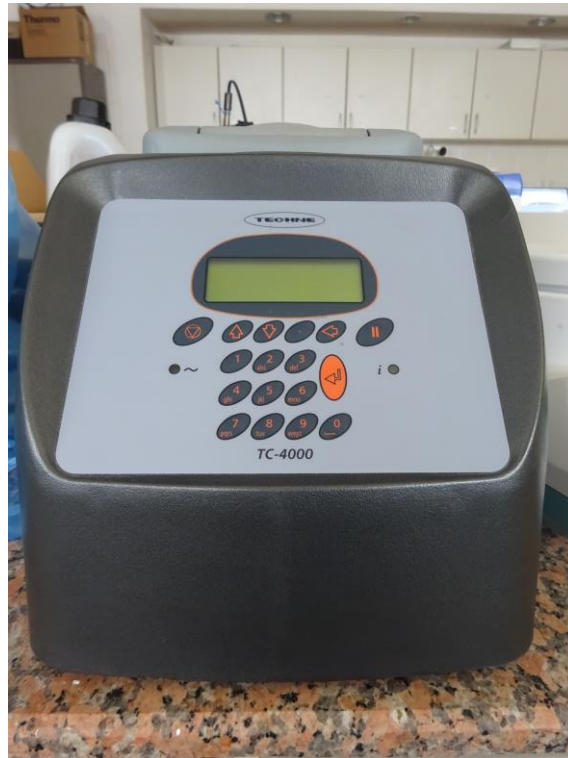
Görsel I.4.b Genetik laboratuvarı Thermal Cycler cihazı
